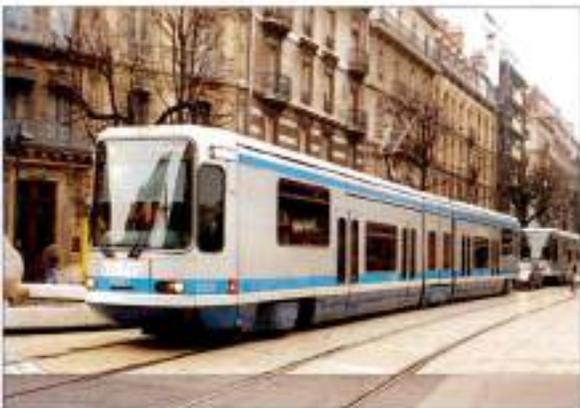
Un tramway à Grenoble. Il s'agit du «tramway français standard» de 2<sup>e</sup> génération, à plancher bas partiel. Il circule également dans les agglomérations parisiennes et rouennaise.
